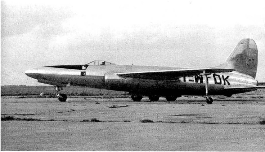
Ce fin monoréacteur, le SO.M-2, est une maquette de vol destinée à tester le concept du bombardier biréacteur SO.4000 qui n'accomplira qu'un seul vol.
