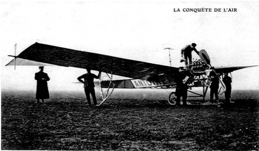
104 Aéroplane ANTOINETTE, monté par M. Eugène Welfringer et actionné par Moteur Antoinette (50 H. P.). — ND Phot.
