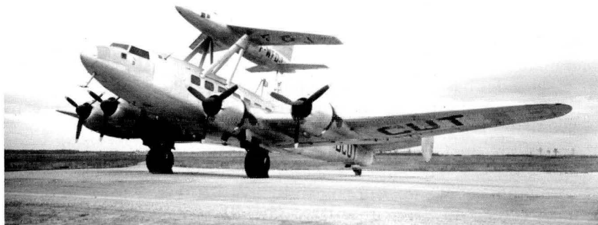
Le SE.161 « Languedoc » n° 31 porteur du SO.M-1, maquette volante non motorisée destinée à l'étude, avec le SO.M-2, du bombardier SO.4000 (photo CEV).
