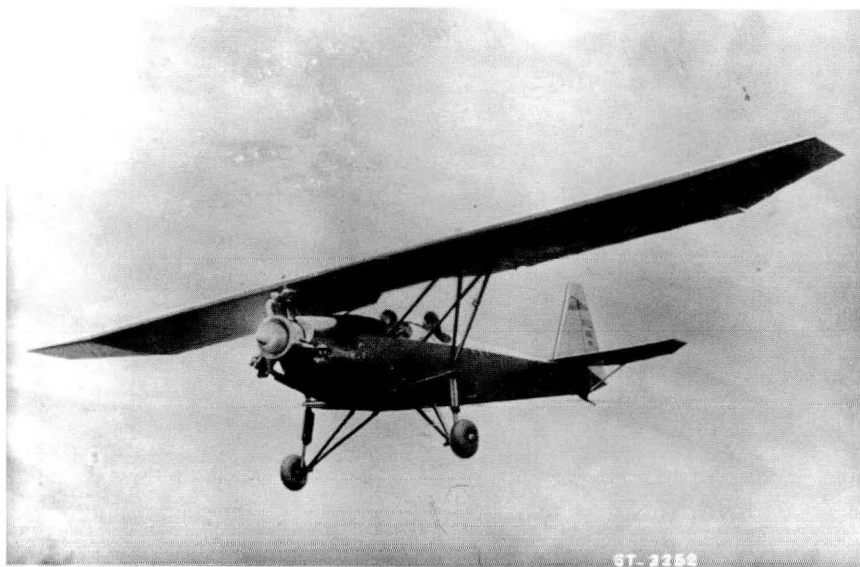
Très prisé par l'aviation populaire, le petit biplace Potez 60, baptisé « Sauterelle », portait un moteur Potez de 60 ch.
