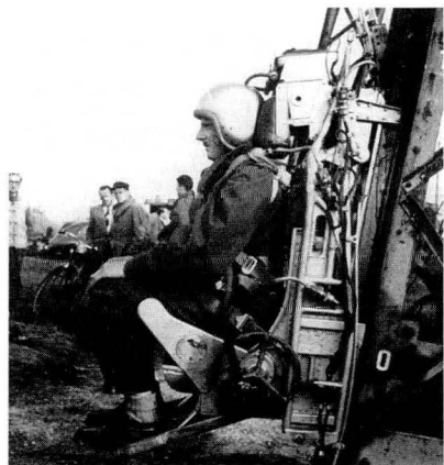
Siège éjectable monté sur la rampe au sol.
