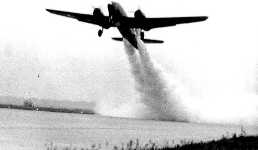
Le spectaculaire décollage avec fusées d'appoint JATO (Jet Assisted Take-Off) du premier exemplaire de série du patrouilleur maritime Lockheed P2V-1 « Neptune ».
